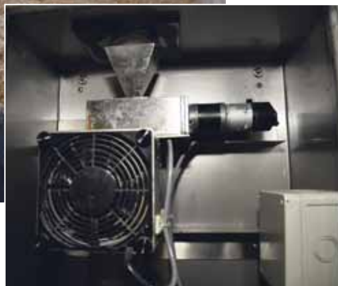
Durch den Luftkanal wird die mit Salz angereicherte Luft in die Box geblasen.
