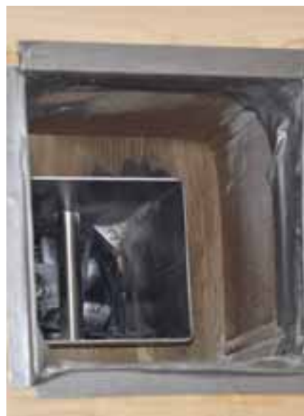
Durch den Luftkanal wird die mit Salz angereicherte Luft in die Box geblasen.
